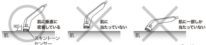
①ハンドピースの照射口が確実に密着すると「ピッピッピッ」と電子音が鳴ると同時に本体に設置されたランプ(Lamp)表示LEDが薄オレンジからグリーンに切り替わり点灯表示され、照射待機状態(レディ状態)になります。
