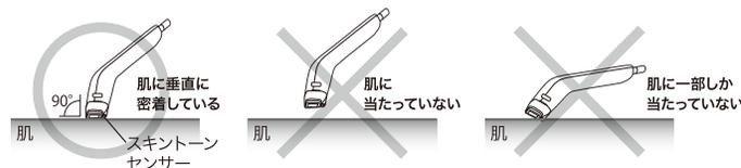
ハンドピースの照射口が確実に密着すると“ピピピピ”と電子音が鳴ると同時に本体に設置されたランプ(Lamp)表示LEDが薄オレンジからグリーンに切り替わり点灯表示され、照射待機状態(レディ状態)になります。
